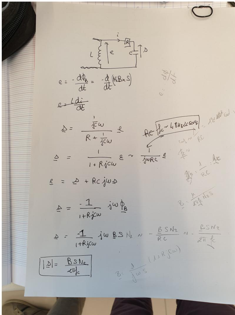
Figure 1: Calculs pour la tension de sortie image de B
