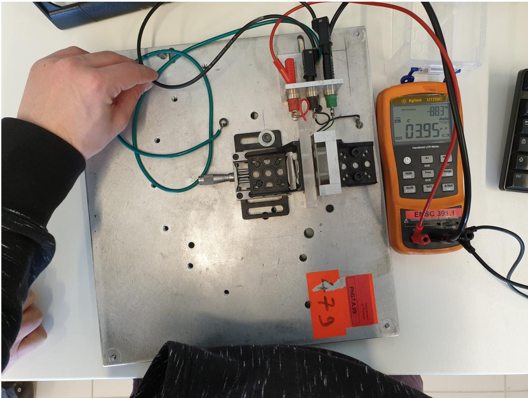
Figure 1: condensateur d'aepinus : la boule est là pour calibrer l'écart entre les armatures (léger ofset)
