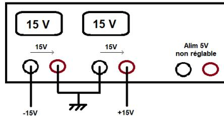
Les deux alimentations indépendantes sont réglées à 15V si c'est la tension choisie, puis on raccorde la borne de bas potentiel d'une des alimentation avec celle de haut potentiel de l'autre (une noire avec une rouge) et on raccorde ce point à la masse du système (souvent par l'intermédiaire d'un oscilloscope). Ce point est alors au potentiel 0. La borne noire qu'on n'a pas encore raccordée est alors à -15V et la borne rouge qui n'est pas encore raccordée est à +15V.
