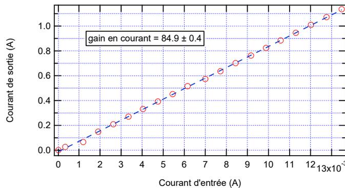
Le gain est proche de 85 ce qui est proche du gain d'un transistor seul. Cet ordre de grandeur est donc bien cohérent et indique bien une amplification conséquente du courant, ce qui explique que par la suite, on négligera la puissance délivrée par le GBF dans le calcul du rendement.
