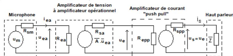
Le microphone délivre une tension u<sub>m</sub> de quelques 10mV avec une résistance de sortie R<sub>sm</sub> de 600Ω environ.
