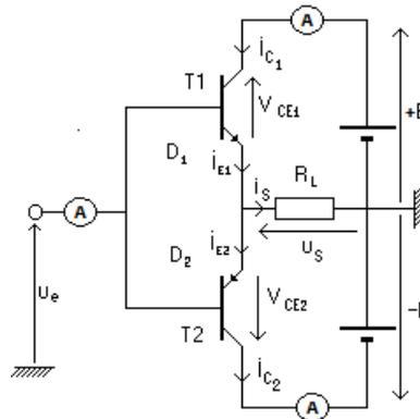
• Les deux tensions de polarisation, +E et -E valent respectivement +15V et -15V dans les expériences faites dans ce document. L'alimentation est une alimentation double avec deux sortie 30V/3A.
