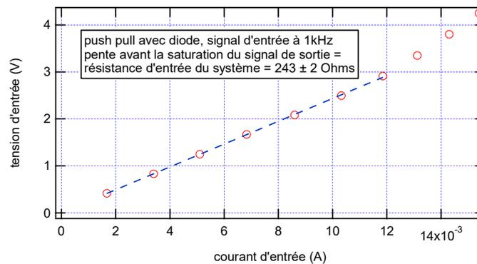
Cette résistance est importante car on doit veiller à ce qu'elle reste forte devant l'impédance de sortie du circuit amplificateur de tension qui précède le circuit push pull, afin d'éviter que la mise en cascade des deux circuits conduise à une baisse du gain en tension de l'ensemble.
