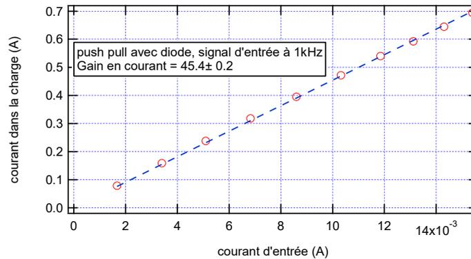
Il faut noter que quand la tension d'entrée augmente (et donc le courant d'entrée), la tension de sortie finit par saturer ce qui demande d'interpréter le gain en courant différemment. Mais on conserve une allure linéaire dans les deux cas.
