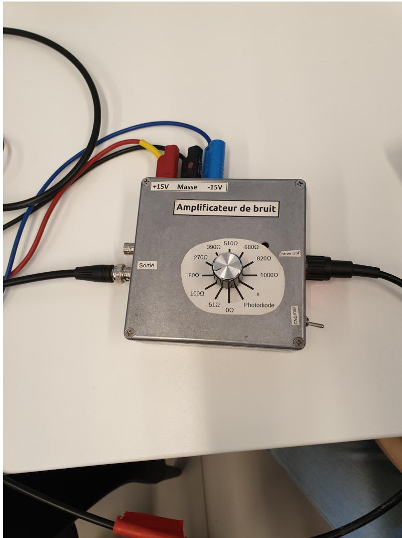
Figure 3: Bruit thermique : boîtier résistances
