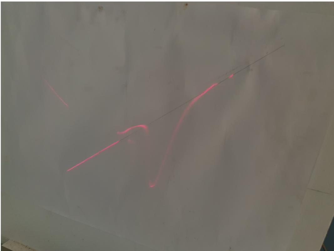
Figure 3: Figure à l'écran. Bien mesurer à l'aplomb du pic, mettre une règle verticale pour bien avoir la verticale
