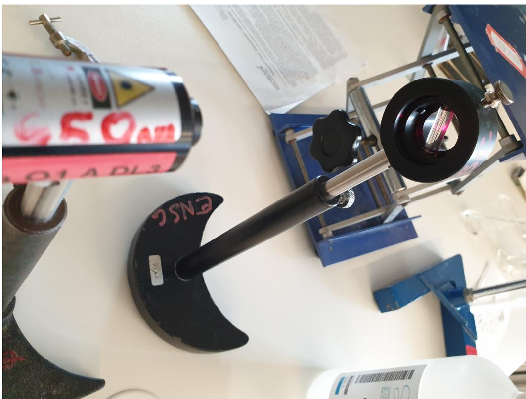
Figure 1: Lentille cylindrique pour faire une nappe laser
