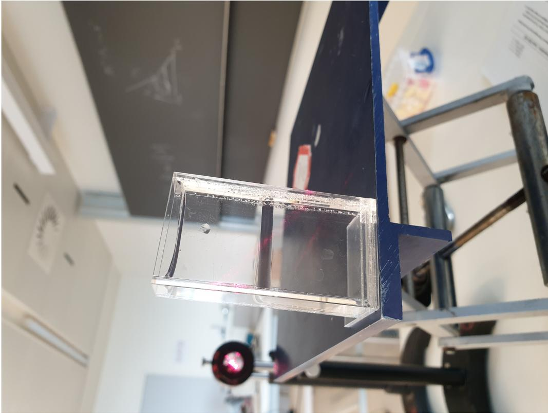
Figure 2: Cuve. En bas : mélange eau-glycérol à 50/50, en haut : eau pure. On voit bien deux séparations
